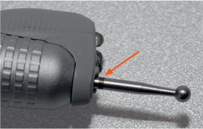
Sobald der Ring auf dem voll eingeschobenem Prüfstift sichtbar ist, sollte eine Reinigung vorgenommen werden.
