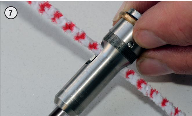
7 Mit einem Pfeifenreiniger können Sie den evtl. vorhandenen Schmutz aus der Schmutzkammer herausstoßen. **WICHTIG:** Bitte vorher einen Fräserprüfstift von vorn bis zur Markierung in das Handstück einstecken.
