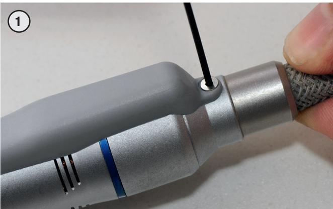
Entfernen Sie die kleine Schraube am Handstückende mit dem beiliegenden Schlüssel.
