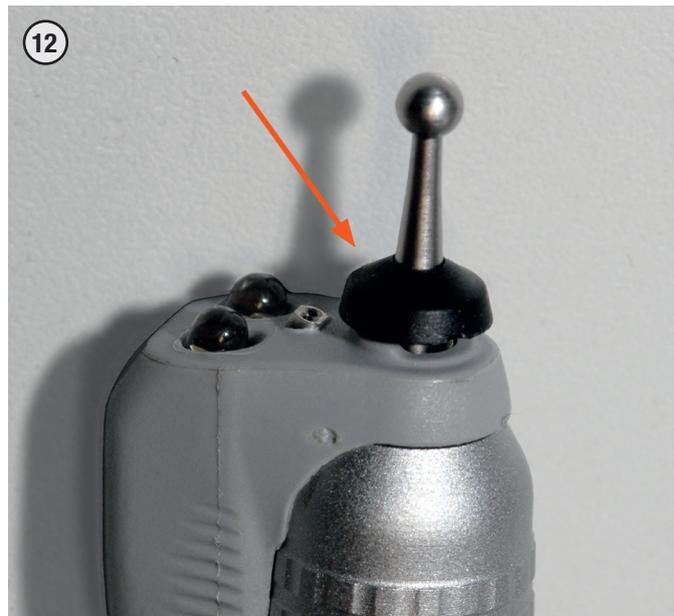
12 Verschmutzte Spraylösung kann am Fräserschiff herunterlaufen und in das Innere des Handstücks eindringen. Die Abtropfkappen (Art.-Nr. 704207330, 12 Stück, € 1,51) verhindern wirkungsvoll die Verschmutzung. Bitte nutzen Sie dieses günstige Angebot und setzen Sie die Abtropfkappen ein. Die Abtropfkappen sind sterilisierbar.
