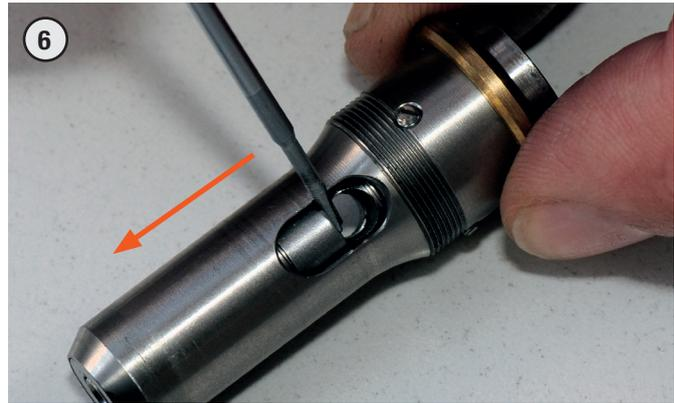
6 Öffnen Sie die Schmutzkammer, indem Sie den Schieber mit einem kleinen Schraubenzieher nach vorn zur Handstückspitze schieben.
