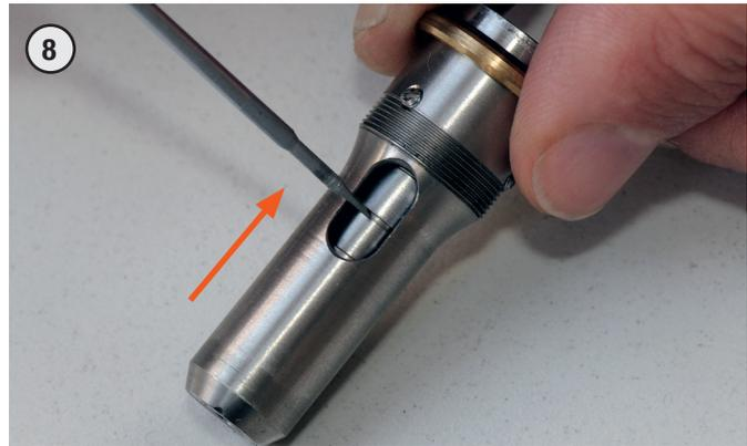
8 Schließen Sie unbedingt wieder die Schmutzkammer, indem Sie den Schieber nach hinten schieben.
