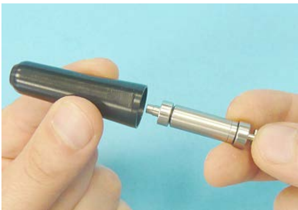
Schritt 6: Beim wieder Montieren wird die Spannkammer in die Welle geschoben und in das Handstückgehäuse eingeführt. Die Verschlussmutter wird eingesteckt und fest angezogen.
