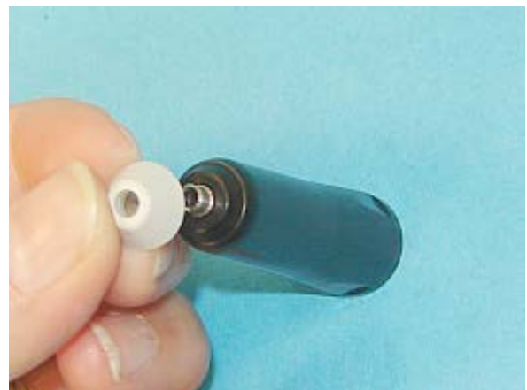
Schritt 7: Dann wird die Staubkappe wieder aufgesteckt.
