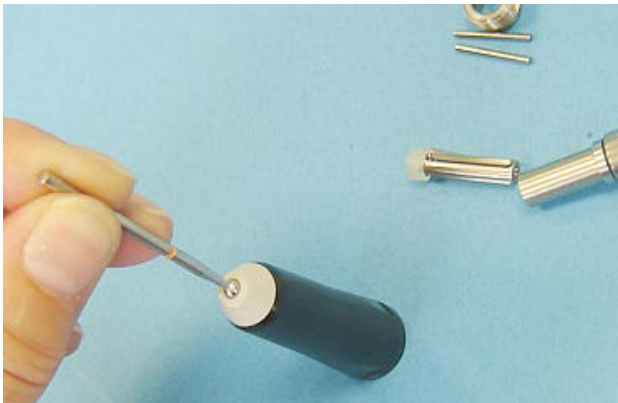
Schritt 4: Nach dem Herausschieben der Spannkammer (Schritt 1 -3) stellen Sie das Handstückgehäuse auf und drücken mit der runden Kuppe des Prüfstifts fest auf die Welle in der Staubkappe.
