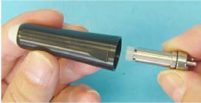
Schritt 6: Die montierte Spannkammer wird in die im Handstückgehäuse verbliebene Welle geschoben.
