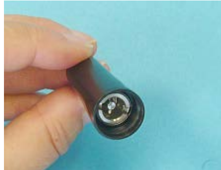
Schritt 7: Die Verschlussmutter wird nun eingesteckt und mit dem Reinigungsschlüssel fest eingedreht.
