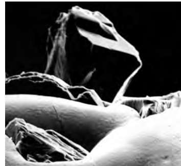
Diamantschleifer: Die Oberflächen von Industriediamanten sind regelmäßiger. Deshalb darf die Körnung ruhig gröber gewählt werden (REM-Aufnahme)
